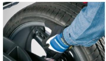
Toque la llanta con el brazo indicador para ingresar las dimensiones de la llanta y seleccione automáticamente el modo de equilibrio de peso.
