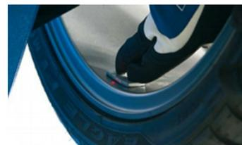
El láser de punta identifica la ubicación exacta de la colocación del peso para una mayor precisión y eficiencia.
