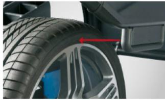
La adquisición automática del ancho de la llanta sin contacto ofrece una mayor precisión y facilidad de uso para un ahorro del 30 % en el proceso completo en comparación con la operación manual.
