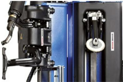
La herramienta sin palanca reemplaza a la palanca para neumáticos convencional. Tira del talón sobre el borde de la llanta, siendo lo más suave posible con el neumático y reduciendo el esfuerzo del operador.
